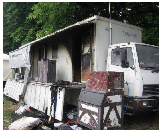
Abb. 66: Aus den Traversenkästen mussten mehrere Gasflaschen entfernt werden. Die vordere Wohnzelle brannte völlig aus.
