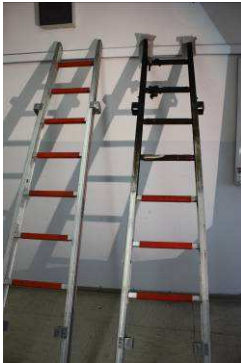
Abb. 60: Die Steckleiter über die sich der Trupp retten konnte weist nach der Durchzündung deutliche Ruß auf. Wegen der enormen Wärmebelastung des Leiterteils ist die rechte Steckleiter nicht mehr nutzbar und hat nur noch Schrottwert.
