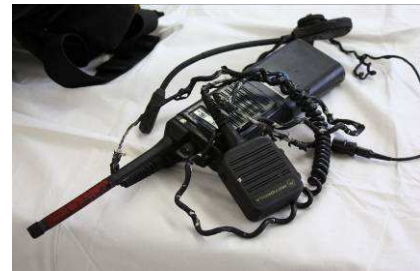
Abb. 59: Das Funkgerät des Angriffstrupps weist starke Verschmorungen auf, teilweise ist die komplette Kabelisolierung abgebrannt.
