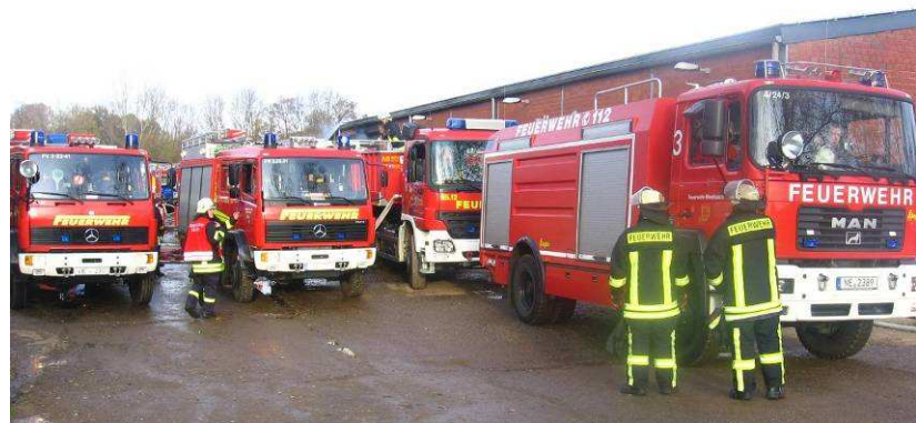
Abb. 75: Eine Vielzahl überörtlicher Tanklöschfahrzeuge verschiedener Größe wurde zur Unterstützung bei der Wasserversorgung angefordert. Das größte Fahrzeug brachte einen Wassertank von 10 000 Litern mit.
