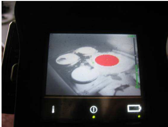
Abb. 57: Blick durch die Wärmebildkamera des Angriffstrupps. Deutlich ist die noch heiße Herdplatte (rote Färbung) zu erkennen.
