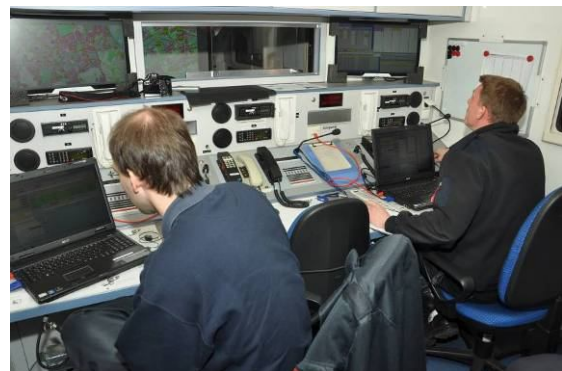
Abb. 6: Zwei Disponentenplätze im Einsatzleitwagen 2, ausgestattet mit Funk, Telefon und Einsatzleitsoftware „Cobra“
